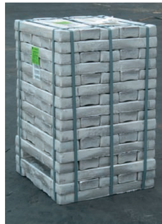
איור 5: ממוצרי מפעל מגנזיום ים המלח מימין מטילי מגנזיום ארוזים למשלוח, משמאל לוחות בצורת T
